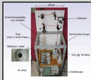
La lumière, émise par la diode LASER, parcourt deux fois le tube avant d'atteindre le détecteur. La position du réflecteur mobile est modifiée afin de faire varier la distance d'une quantité  $\Delta D$ . Le détecteur convertit ensuite l'intensité lumineuse en signal électrique visualisé sur l'oscilloscope.
