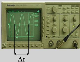
Le retard  $\Delta t$  est mesuré sur l'oscilloscope par rapport à une référence (trait vertical). Lorsque la distance  $D$  varie, la sinusoïde se décale donnant accès à une nouvelle mesure de  $\Delta t$ .
